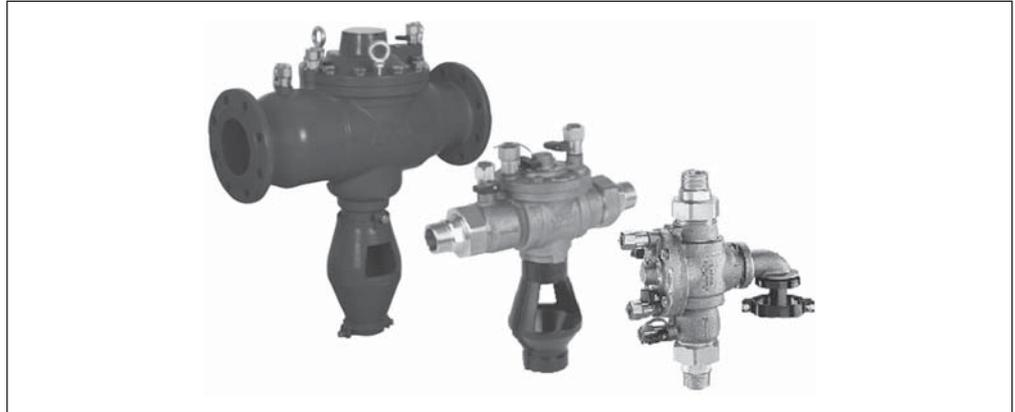
Защита сетей осуществляется автоматическим прерыванием водоснабжения абонента с последующим опорожнением клапана и удалением поступившей от абонента воды с возможными загрязнениями в дренаж. Все клапаны поставляются проверенными на работоспособность в заводских условиях. Конструкция обратных клапанов типа BA2760, BA2760CD, BA4760 позволяет проводить периодическую проверку на работоспособность без демонтажа и прекращения подачи воды абоненту.
