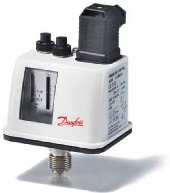
Серия BCP предназначена для автоматизации и технологической защиты паровых и водогрейных котлов. Реле давления оснащено однополюсным перекидным контактом, который меняет положение в зависимости от соотношения давления среды и уставки. В случае ответственных применений рекомендуется использовать реле с функцией защиты.
