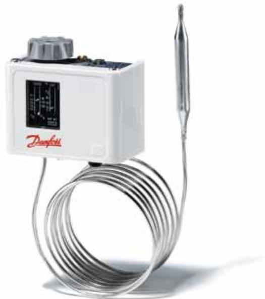
Реле температуры КР производства компании Danfoss используются для систем регулирования, контроля и аварийной сигнализации в промышленных установках. Реле температуры КР — это автоматические реле, положение контактов которого зависит от температуры контролируемой среды. Эти устройства снабжены однополюсным переключателем на два направления (SPDT) и могут непосредственно управлять работой однофазных двигателей переменного тока мощностью до 2 кВт.
