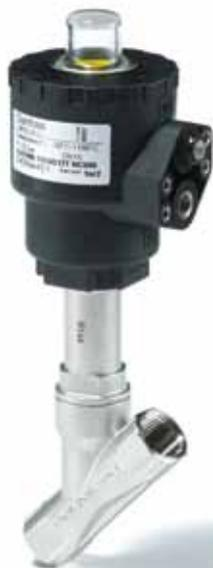
AV210 — угловые пневматические клапаны, предназначенные для использования в жестких промышленных условиях. Клапан может работать при очень высоких температурах и значениях вязкости рабочей среды и нечувствителен к частицам грязи, содержащимся в этой среде. Клапаны выпускаются с корпусом из бронзы (RG5/бронза) или нержавеющей стали (AISI316).
