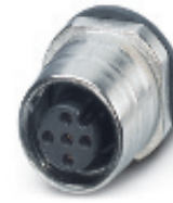
Гнездовая контактная вставка M12, подключение под углом 180°, с M12-SPEEDCON креплением
