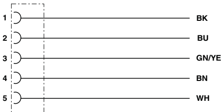
Цоколевка контактов 7/8"-вилки/розетки M8, тип кабеля 400
